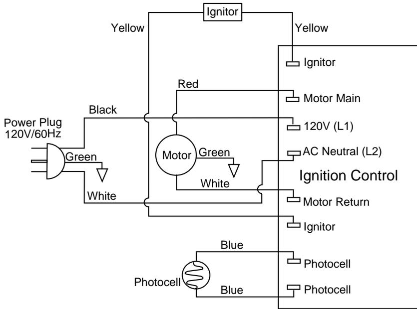
**Figure 20 - Wiring Diagram**
